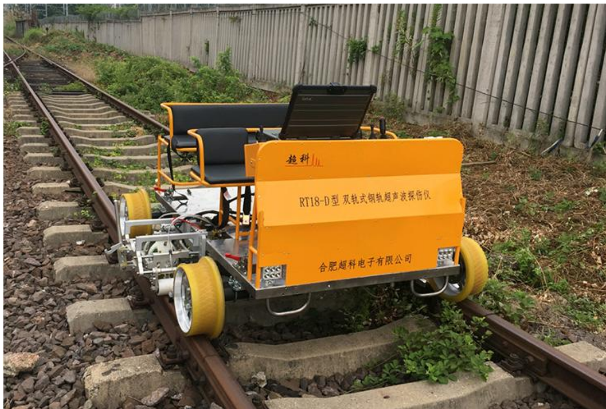
图 7 双轨式超声探伤仪（合肥超科有限公司）
